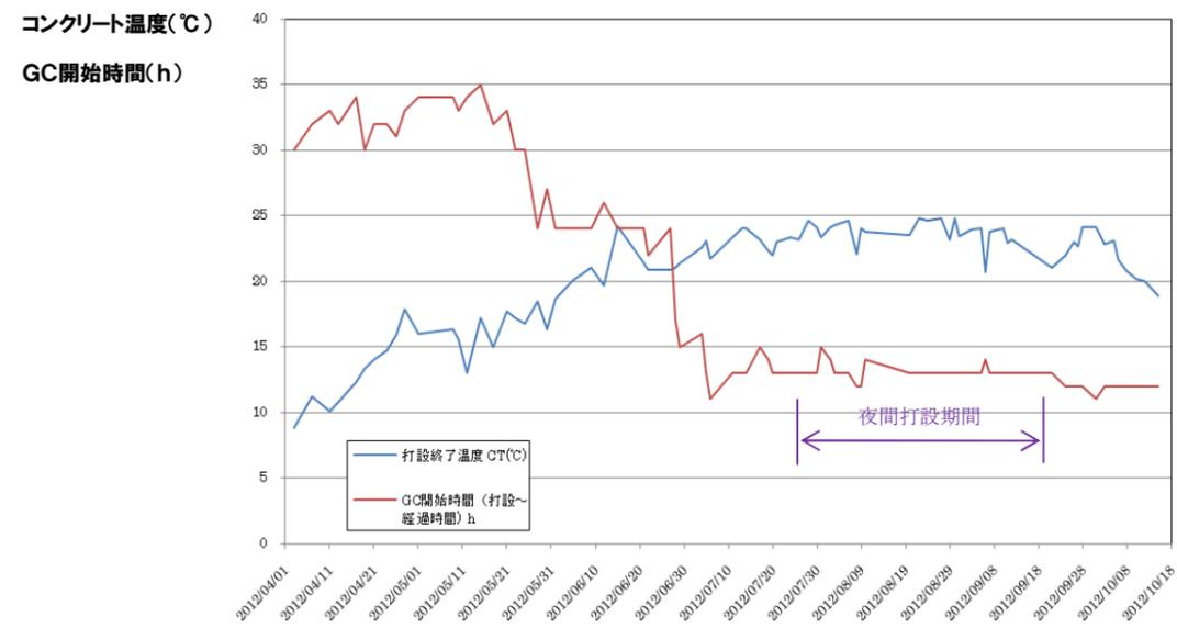
図 3.4.25 打設終了時温度とグリーンカット開始時間(打設～経過時間)
