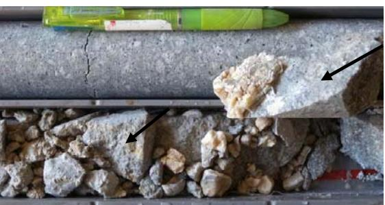
写真 3.5.1 PR7 (パイロット) 孔 18st に認められるかみ合わせが悪い割れ目
