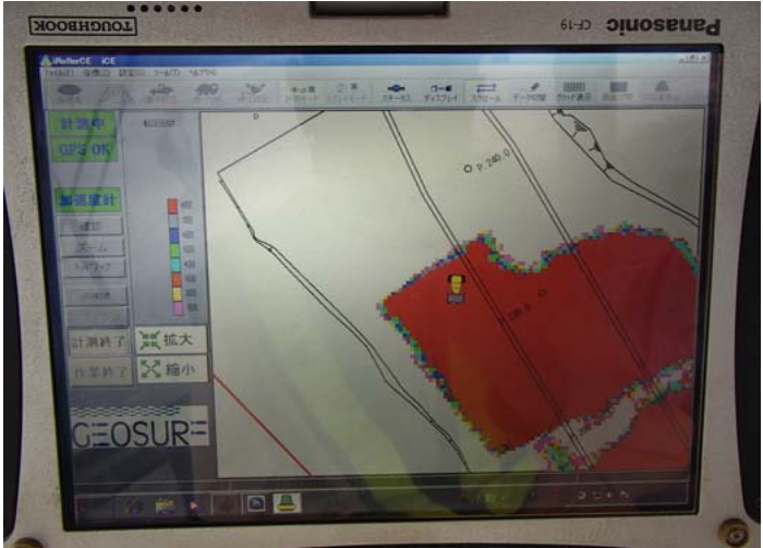
写真 3.6.5 転圧軌跡管理 (例)
