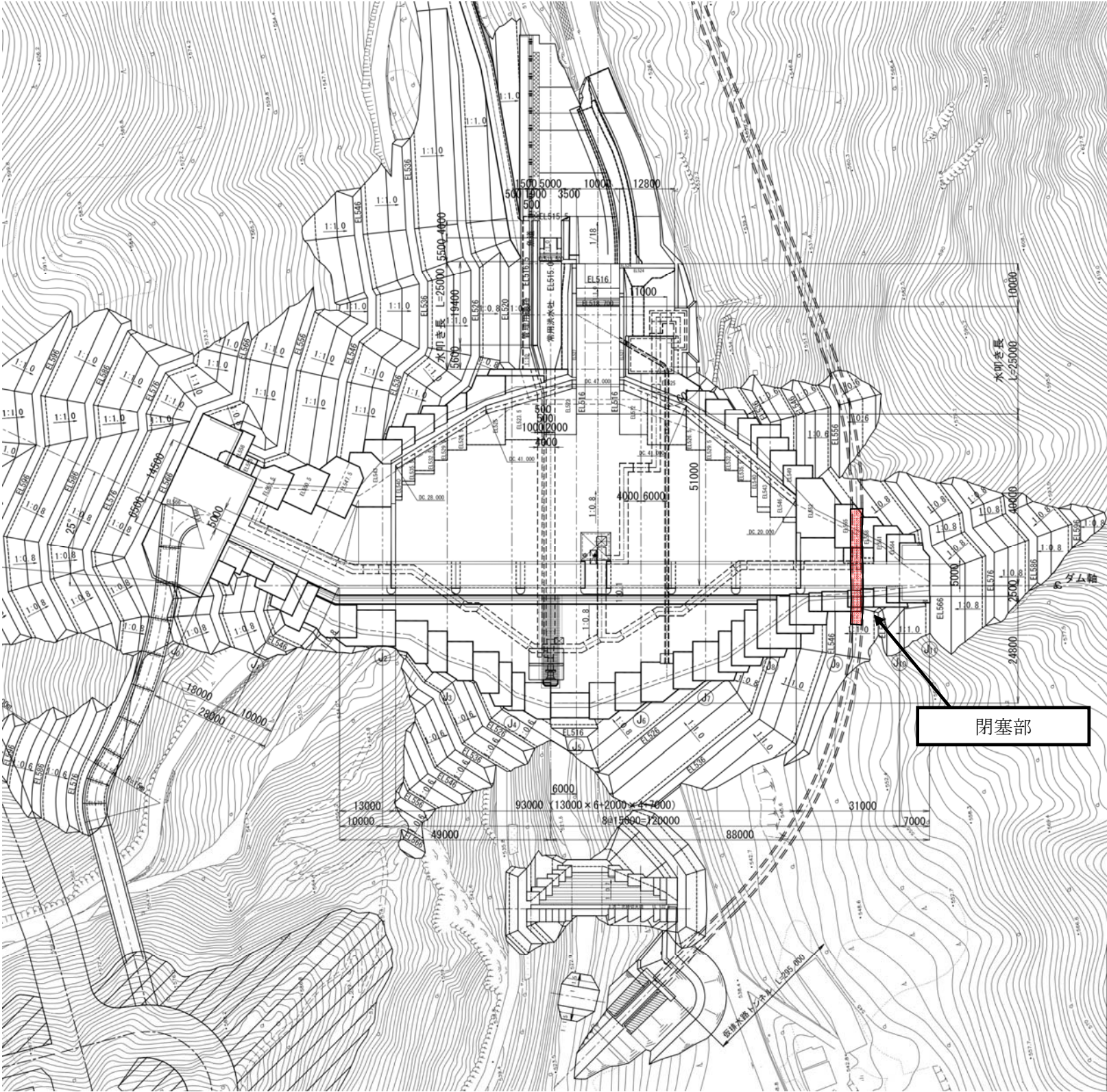
図 3.7.1 閉塞工配置図
