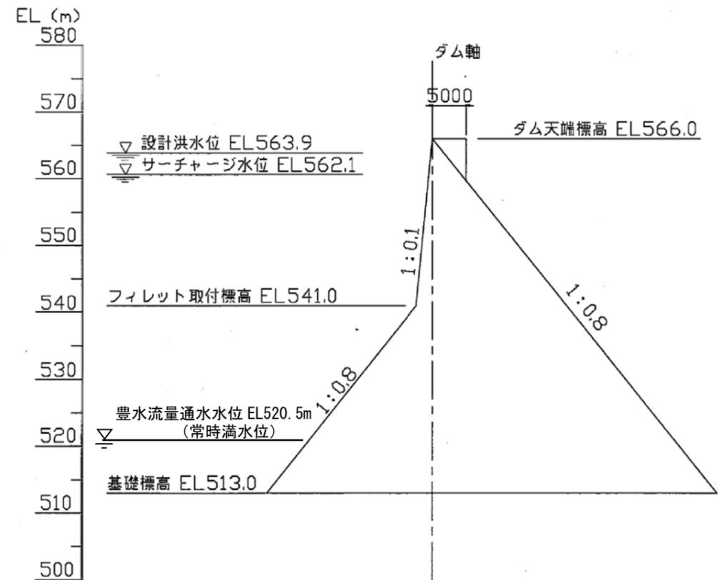
図 3.3.3 堤体標準断面基本形状
