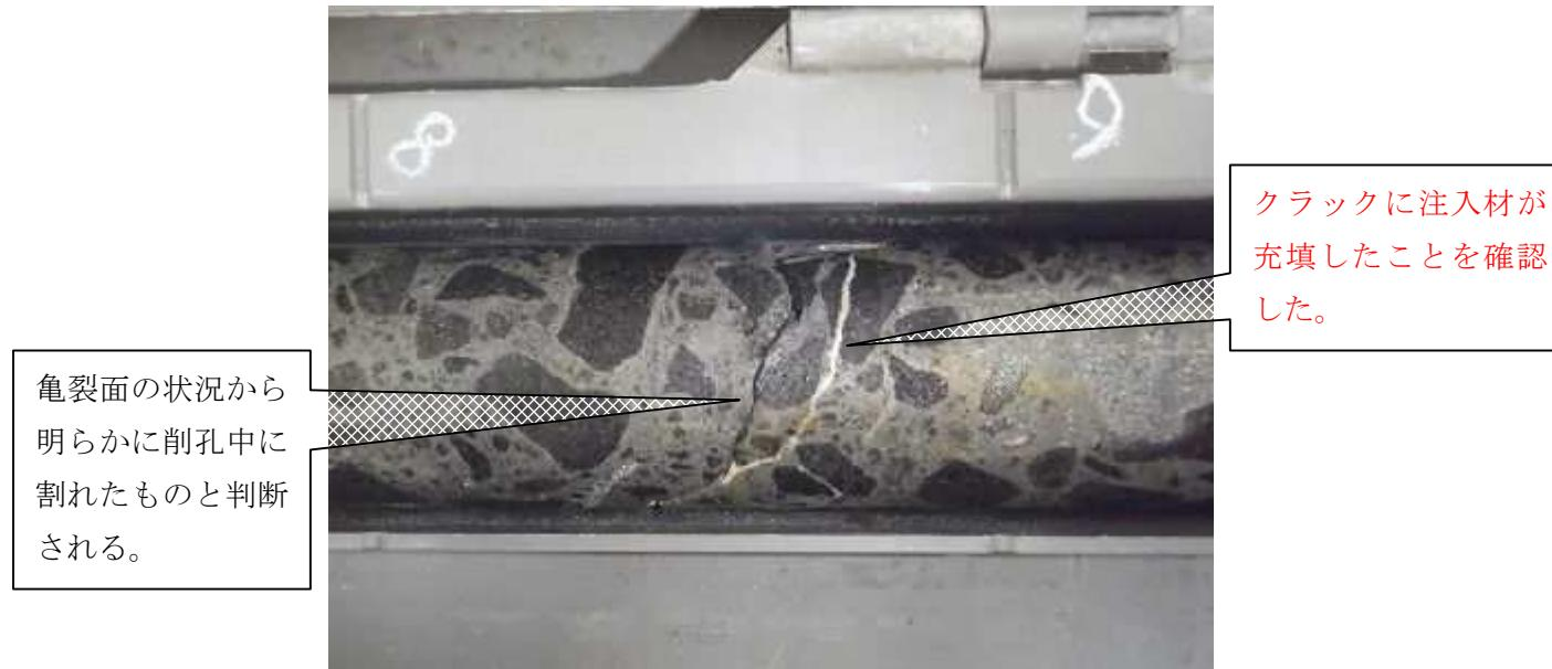
写真 3.4.37 注入材の確認されたクラック例(No.2 C-02B01)
