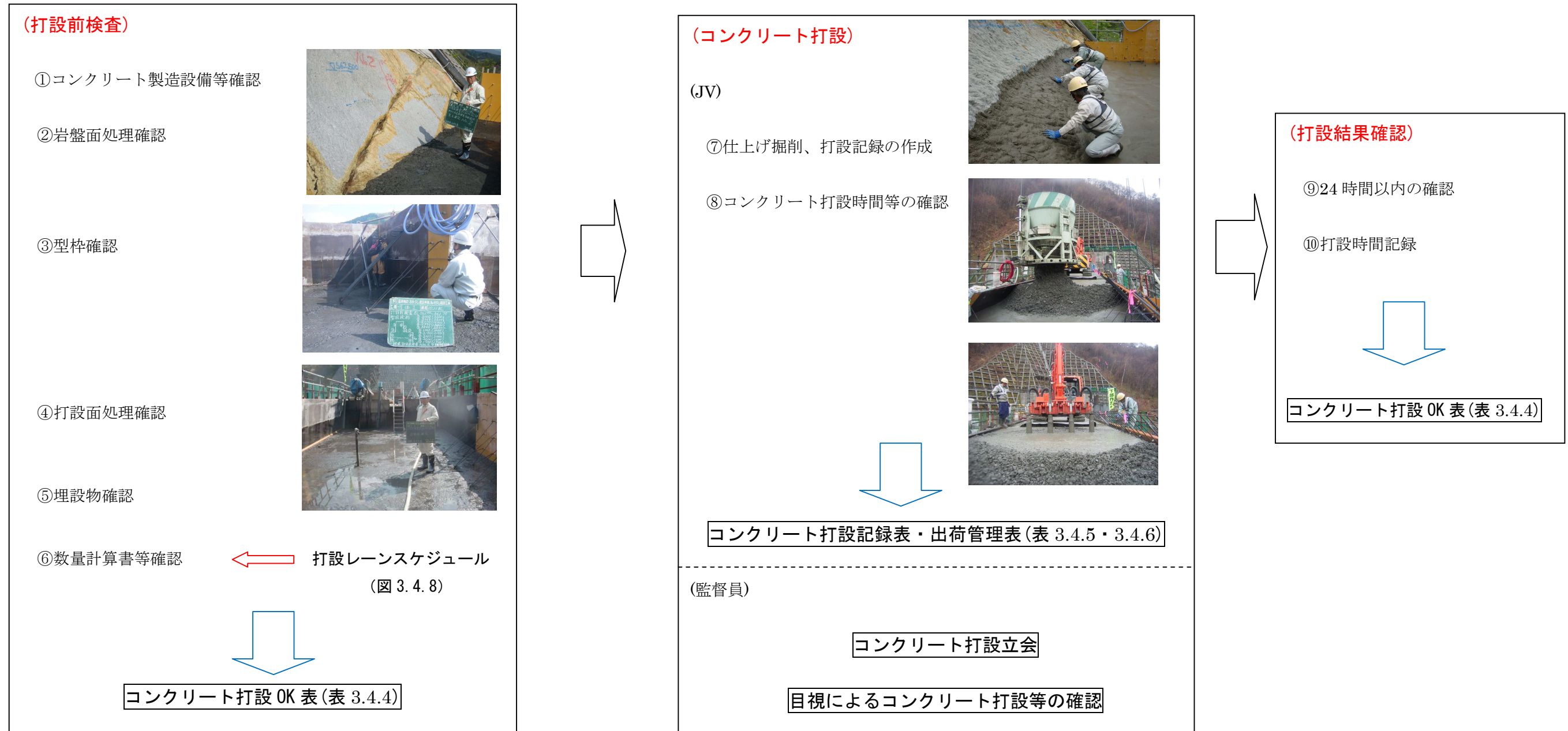
図 3.4.7 コンクリート施工管理フロー図
