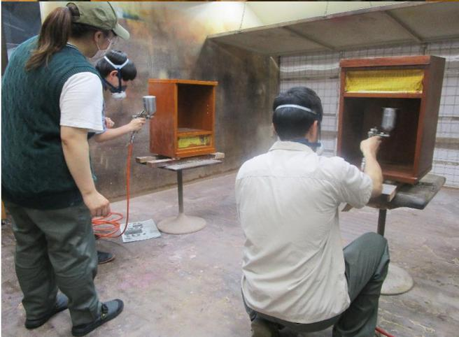
塗装の実習も行っています。手板を用いた塗装実習の後に、実物の製品に塗装を施します。昨年度の訓練生が製作していた整理箱に、塗装しているところです。とても艶がある仕上がりになっていました。
