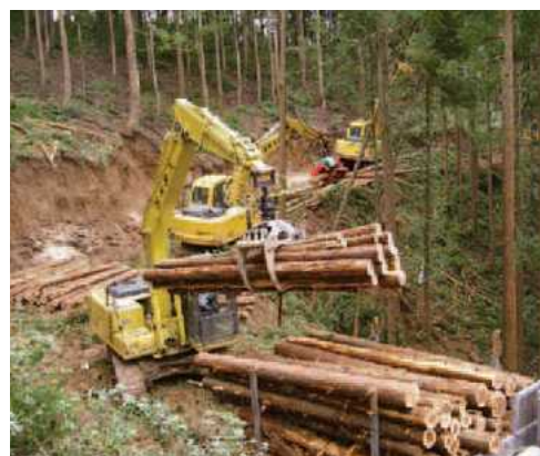
【写真Ⅰ】作業路を開設し、高性能林業機械を使って間伐材を搬出（兵庫県八木木材）
