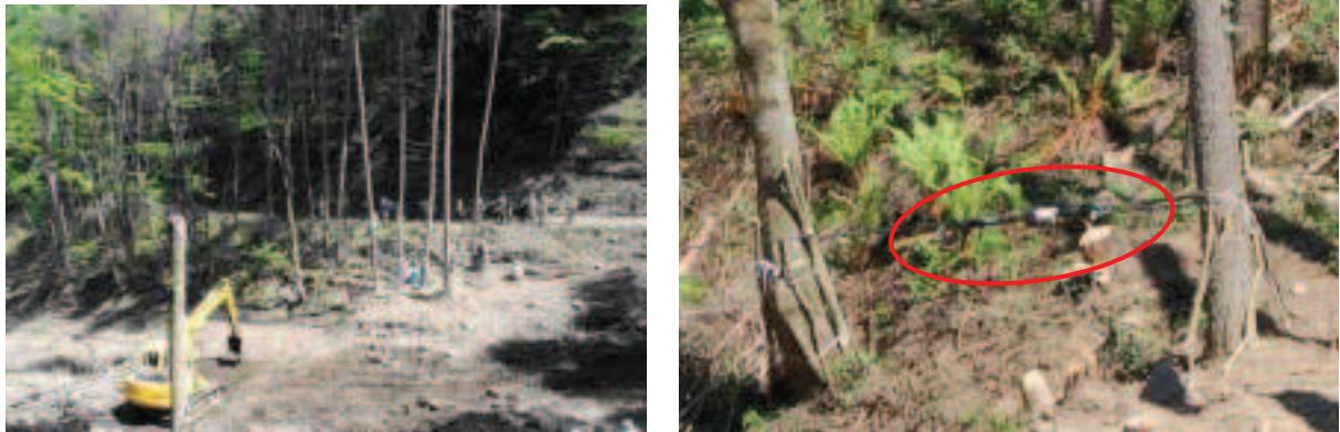
【写真-3 原位置立木の引き倒し試験(左:試験状況、右:荷重計測器・写真中央赤円)(2007.5.15)】
