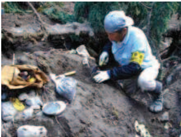
【写真-6 土壤透水性試験に使用する 土壤サンプルの採取状況】
