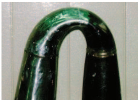
(180度曲げても破損しない溶接鋼管)
