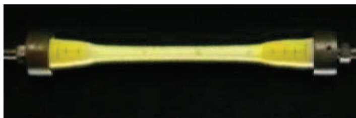
(これだけ伸びても破損しないポリエチレン管)
