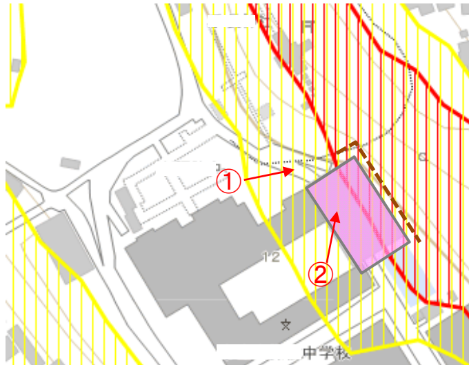
【事例2】 公共建築物(学校体育館)裏にシートパイルによる壁を設置
