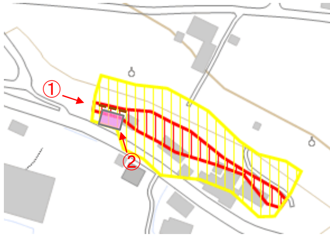
【事例2】 公共建築物(学校体育館)裏にシートパイルによる壁を設置
