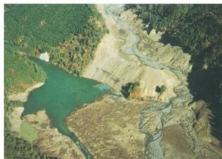
「御嶽崩れ」の土砂により王滝川がせき止められてできた天然ダム
