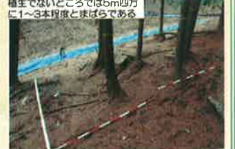
風化した凝灰岩と崩壊土の隙。凝灰岩は遮水層を形成する
