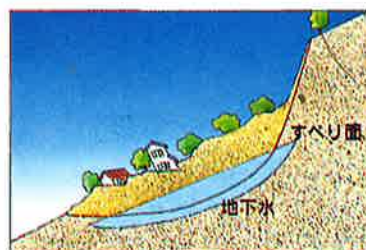
地下水水位が上昇することにより浮力が発生し、土塊がすべり始めます。
