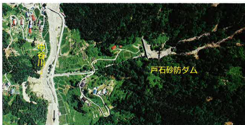
砂防ダムが下流域を保全（小谷村戸石沢・戸石砂防ダム）
