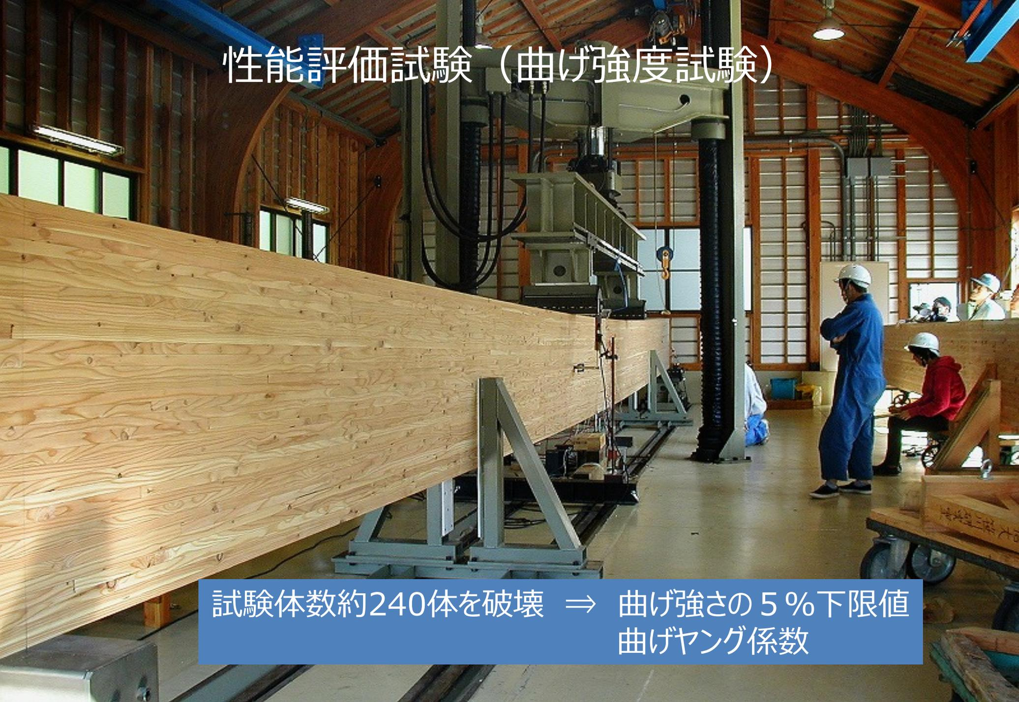
試験体数約240体を破壊 ⇒ 曲げ強さの5%下限値
