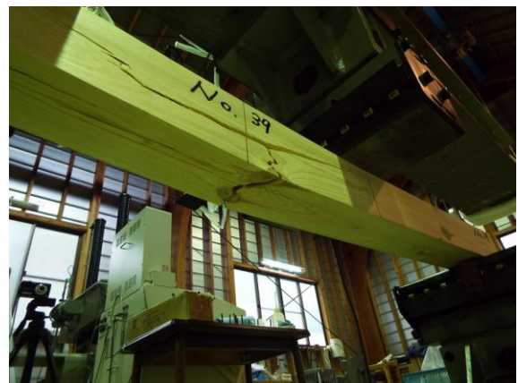
写真-2 曲げ破壊状況（圧力併用式） （曲げ強さ最小値）
