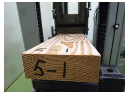
写真-3 外層エレメント曲げ試験 木表荷重(フラットワイス)
