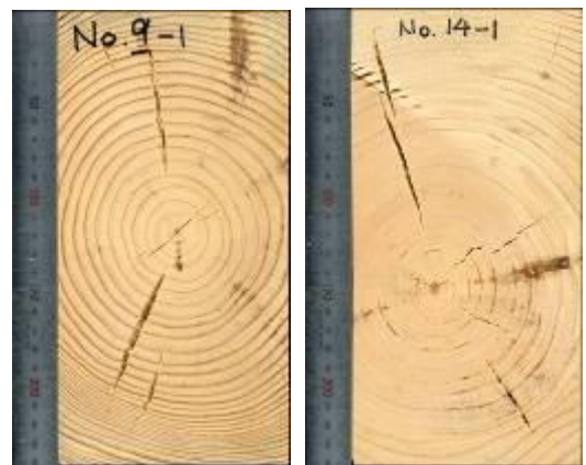
写真 蒸気・圧力併用型乾燥材に発生した内部割れ
