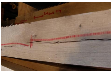
写真-2 人工乾燥後材面割れ
