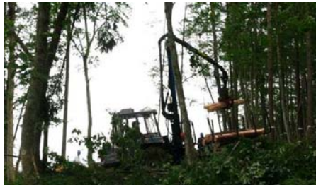
写真 先進的林業機械による皆伐作業 (上:ホイール式ハーベスタ、下:ホイール式フォワーダ)
