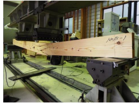
写真-1 中心エレメント曲げ試験 (エッジワイス)
