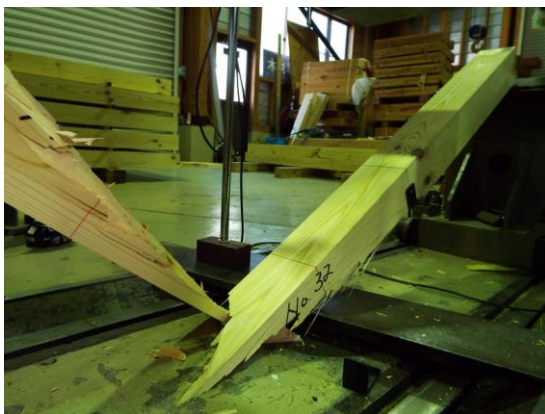
写真-1 曲げ破壊状況（蒸気式） （曲げ強さ最小値）
