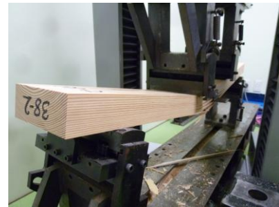
写真-2 外層エレメント曲げ試験 木裏荷重(フラットワイス)
