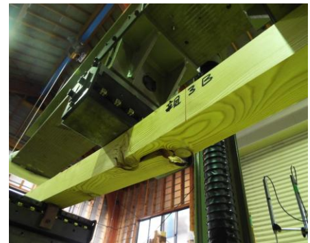
写真 節から曲げ破壊した試験体
