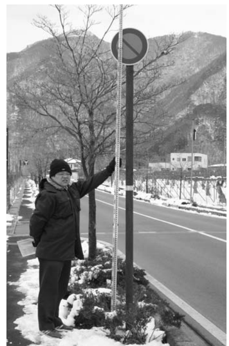
写真-1 木製標識柱の地上高
