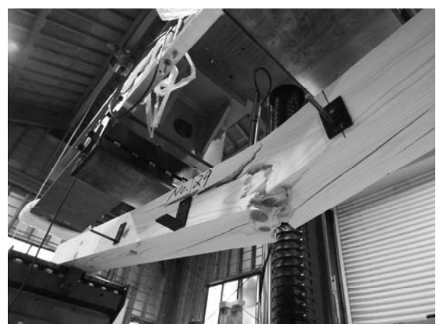
写真-2 節からの曲げ破壊状況
