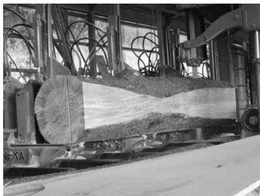
写真-5 松くい虫被害材の製材の様子
