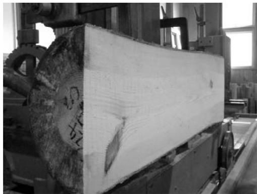
写真-3 伐倒 1 か月時の製材の様子
