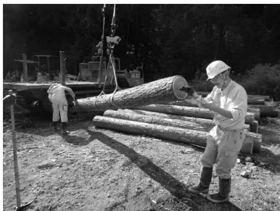
写真2 丸太を吊り上げ、固有振動数を測定
