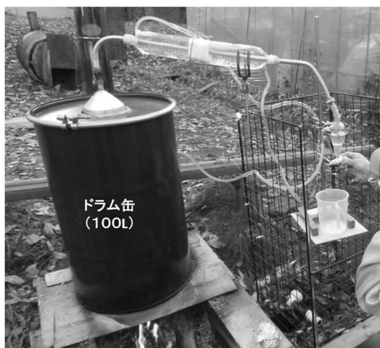
写真-1 ドラム缶装置 (初期型・直火式)
