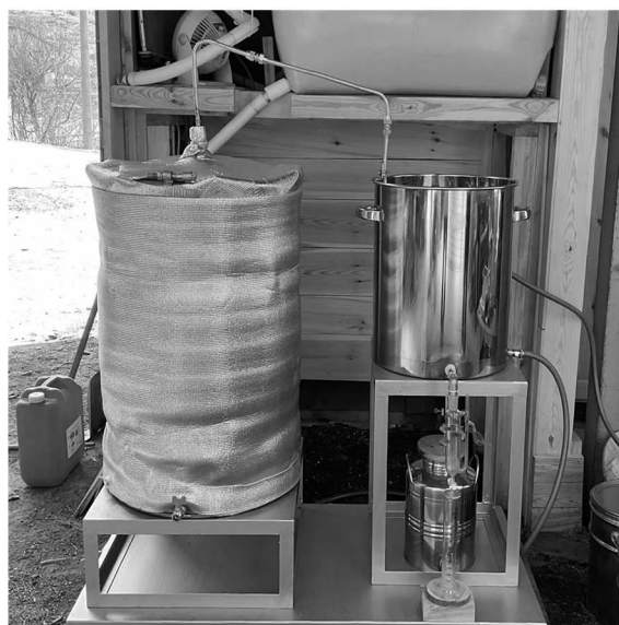
写真-5 ドラム缶装置（電気式）
