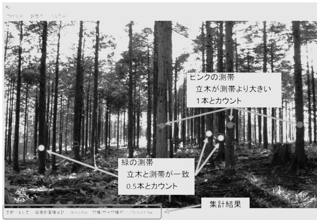
写真-4 簡易林分計測ツールに取り込んだ画像
