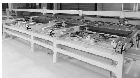
写真-1 左：目視等級、右：機械等級（グレーディングマシン）
