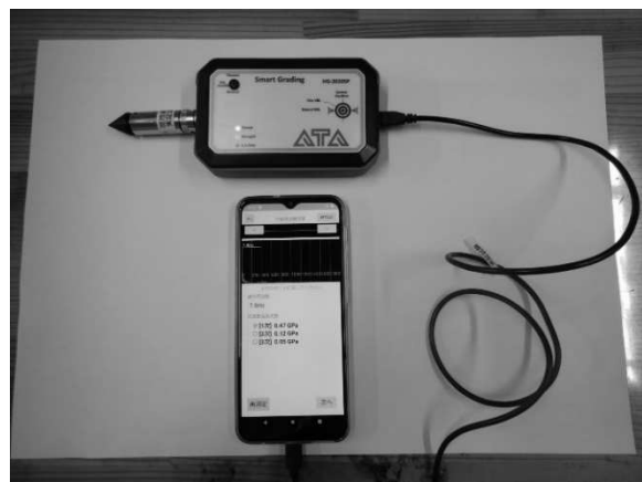
写真3 ATA社製の原木強度測定器
