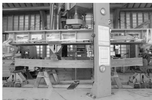
写真-3 左：平角材と蒸気式乾燥機（イメージ）、右：曲げ試験機
