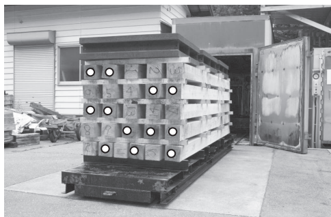
写真 1 乾燥棧積みの様子 （○印：心持ち材）
