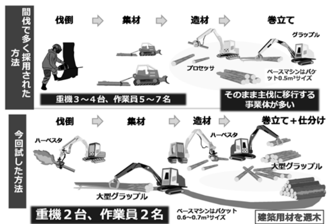
図-1 北海道においてカラマツ間伐で多く採用された生産システム(上段)と今回試した生産システム(下段)
