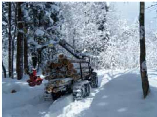
写真 5-8 多雪地帯で稼働するホイール式ハーベスタ（左）と 6～8t 級フォワーダ（右）
