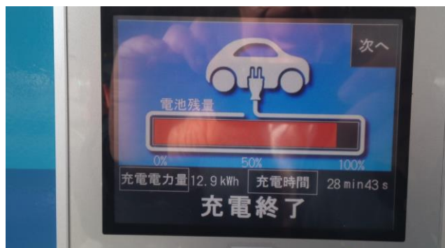
中央自動車道SAに設置されている急速充電器の画面表示
