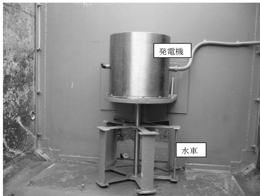
図 4-2 ダリウス水車外観（下流より）
