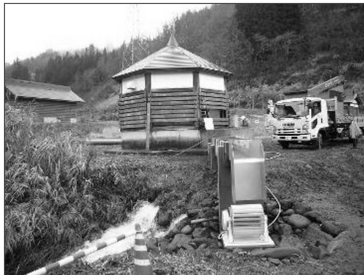
図 4-8 開放型貫流水車概要
