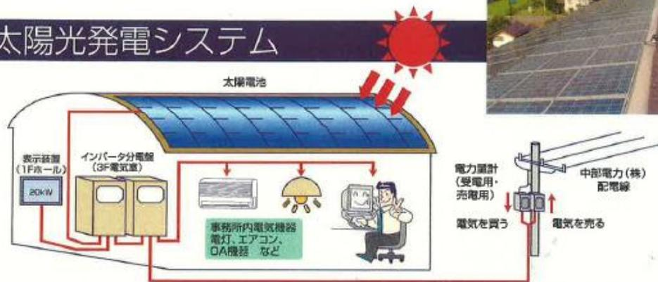
太陽光を受けた太陽電池は直流電流を発生します。それをインバータによって交流電流に変換して、事務所内の電気機器に使います。
