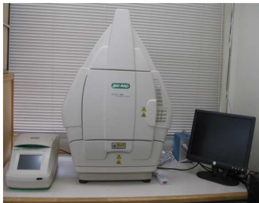
【微生物の多様性を評価する DGGE 解析装置（野菜花き試験場）】
