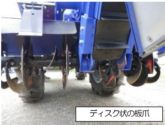
図1 うね内部分施肥機の施肥部分
