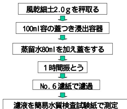
図 1 土壌の水浸出りん酸の簡易測定手順
