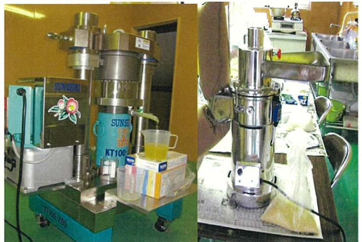
【搾油機／製粉機の設置】
