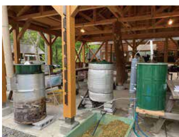
▲精油を抽出できるドラム缶蒸留器
