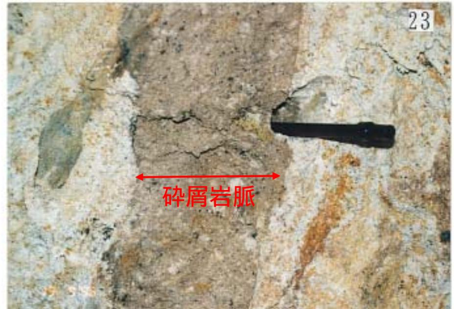
・F - 9は、凝灰質の碎屑岩脈が伴っており、これは変質してるため、一部では溶脱して開口割れ目のようになっています。
