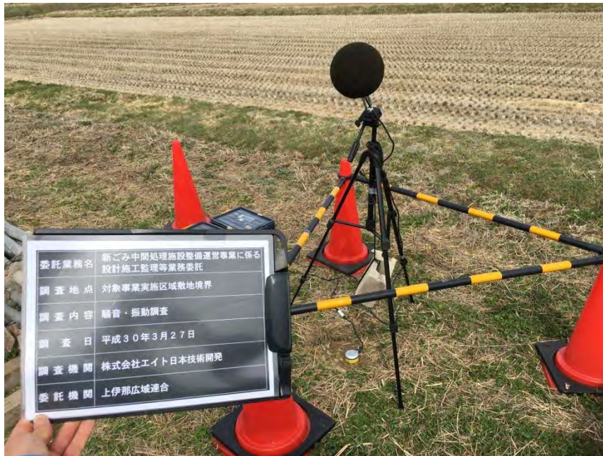
□騒音・振動測定状況（工事区域敷地境界地点）
