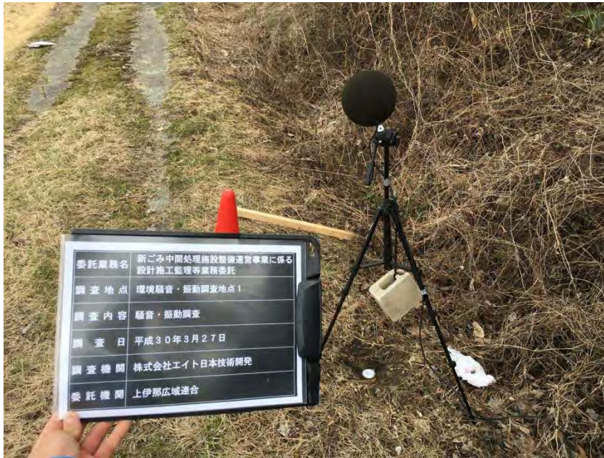
□騒音・振動測定状況（周辺地域 東側地点）
