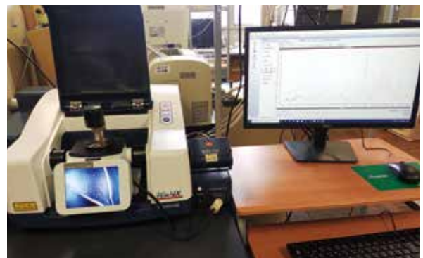
写真3 MPsの素材を判定する赤外分光光度計
