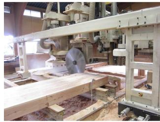
JAS集材加工施設装置（CNCマシン）
