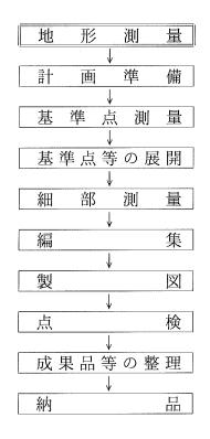
平板原図又は数値地形データを図式に従い編集 地形図原図(写図)
