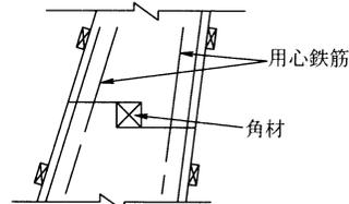
図1 打継目施工
