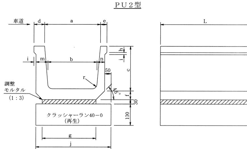
PU2型(車道用鉄筋コンクリートU型側溝)寸法および材料表
