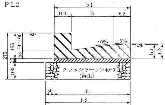
PL2型(プレキャスト鉄筋コンクリートL型側溝)寸法および材料表
