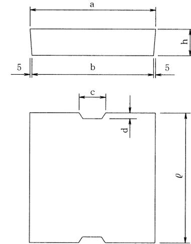
PU3型 特殊車道用鉄筋コンクリートU型側溝寸法および材料表
