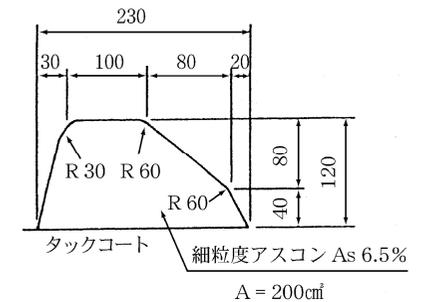
※舗装材料は、再生材の使用を原則とする。
