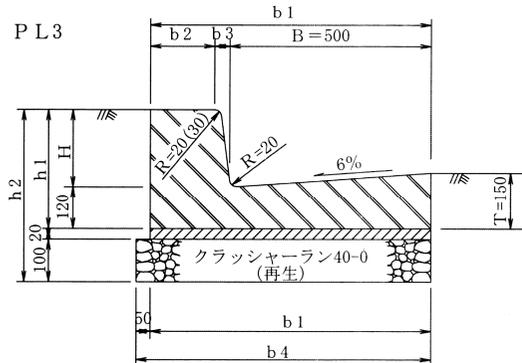
PL3型(プレキャスト鉄筋コンクリートL型側溝)寸法および材料表
