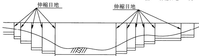
図3 基礎地盤が変化している場合
