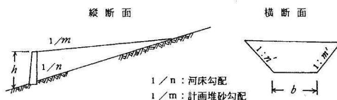
図 3.3.7(a) 概略貯砂量の概念
