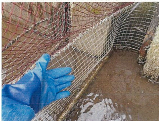
図4 改良された池尻川逸出防止装置 上段：装置1(奥)、装置2(手前) 中段：装置3 下段左：装置1と2のステンレス製網の目合い 下段右：装置3のステンレス製網の目合い
