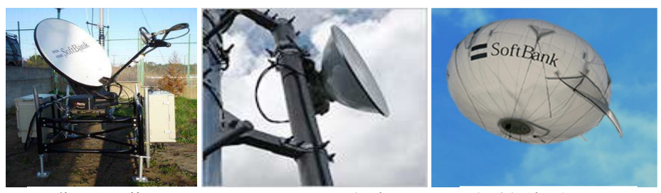
可搬型移動基地局 エントランス無線 気球無線中継システム （提供：ソフトバンク（株））
