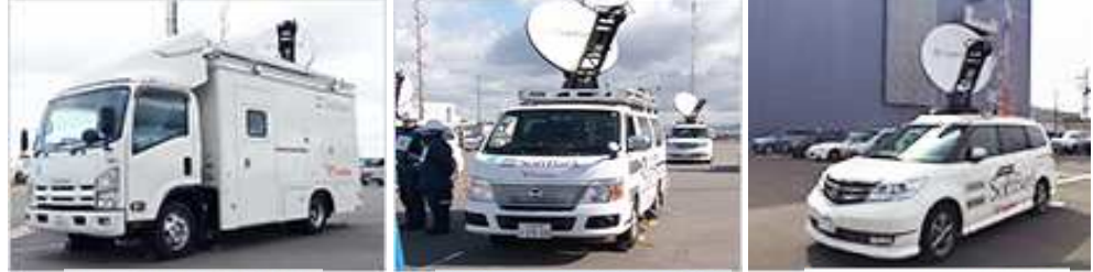
大型移動基地局車 中型移動基地局車 小型移動基地局車
