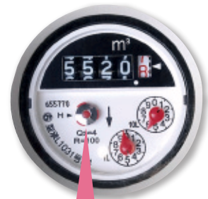
〈水道メーター〉
