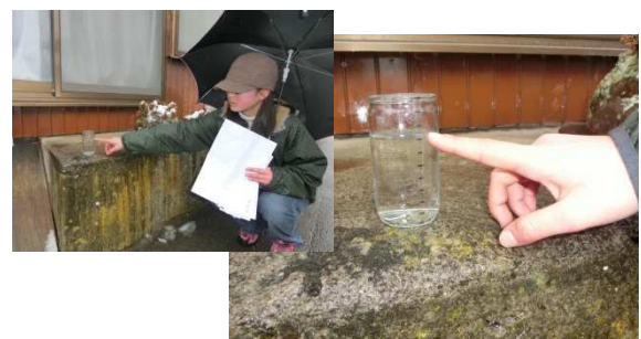
ワンカップ瓶による簡易的な雨量計測を自主避難の判断に使用
