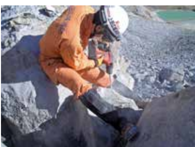
削岩機を使って岩を割り砕く（長消）
