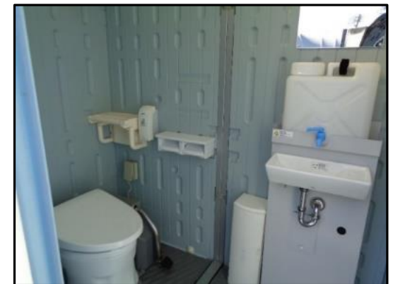
簡易水洗機能、洗面台等を備えた「快適トイレ」
