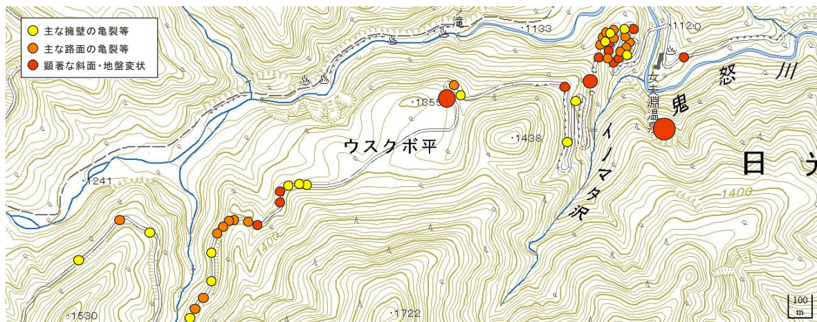
図 4.6.2-5 2013年2月25日栃木県北部を震源とする地震による主な斜面・地盤変状の分布(若井, 2013)
